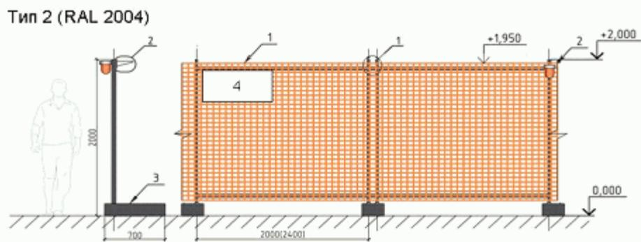
1 - панель рамная; 2 - сигнальный фонарь; 3 - опорный бетонный блок
