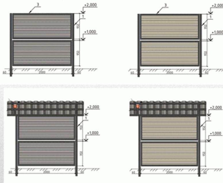
**1 - стойка, металлическая труба (RAL 7016)**
