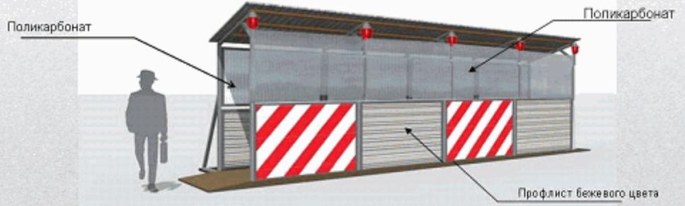
Вариант 1 (без заполнения поликарбонатом фасадной части галереи)
