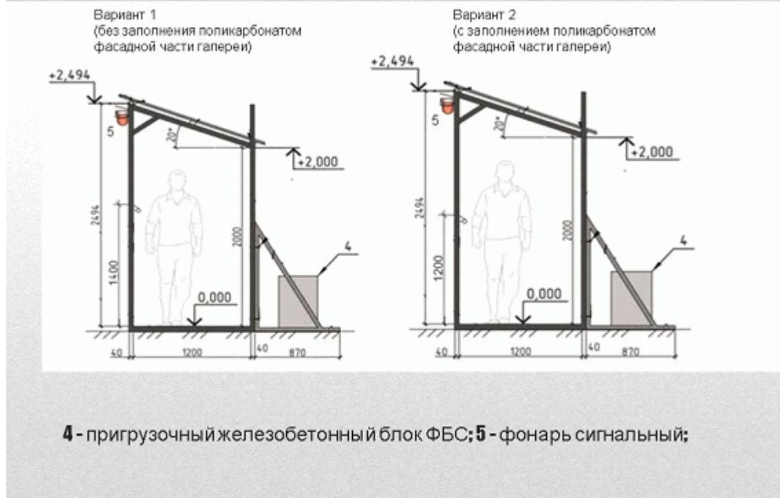
**Ограждение строительной площадки из металлической сетки**
