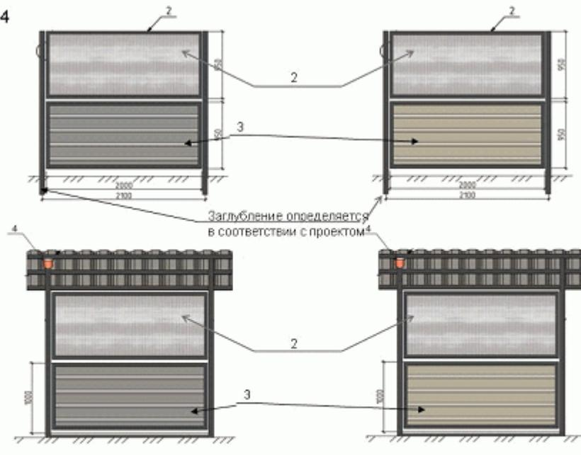
**1 - рама из металлического уголка 40х40 мм; 2 - панель рамная, уголок 40х40 мм, заполнение - поликарбонат;**
