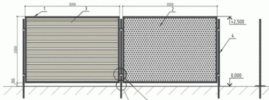
1 - рама из металлического уголка 40x40 мм; 2 - металлическая сетка (RAL 7042, 7032); 3 - профлист (RAL 7042, 7032); 4 - стойка, металлическая труба (RAL 7016)
