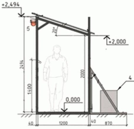
Вариант 2 (с заполнением поликарбонатом фасадной части галереи)
