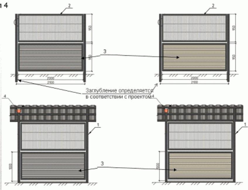
**2 - панель рамная, уголок 40х40 мм, заполнение - металлическая сетка (RAL 7042, 7032);**
