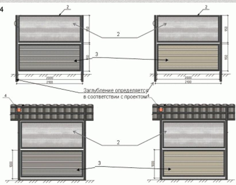
1 - рама из металлического уголка 40x40 мм; 2 - панель рамная, уголок 40x40 мм, заполнение - поликарбонат;
