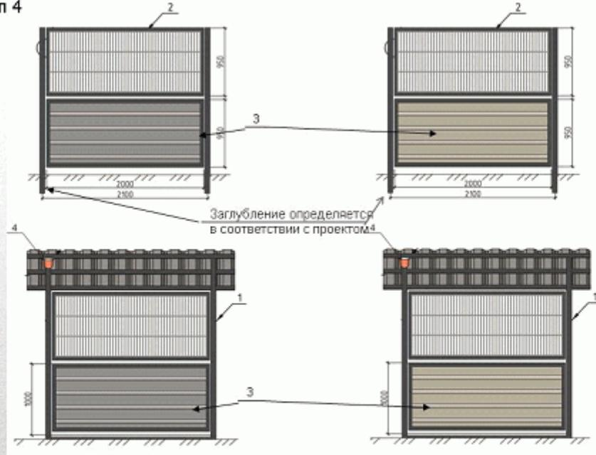
2 - панель рамная, уголок 40x40 мм, заполнение - металлическая сетка (RAL 7042, 7032);
