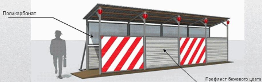
Вариант 2 (с заполнением поликарбонатом фасадной части галереи)
