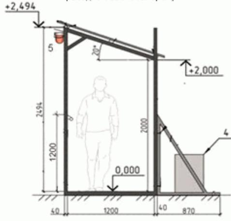
**4** - пригрузочный железобетонный блок ФБС; **5** - фонарь сигнальный;
